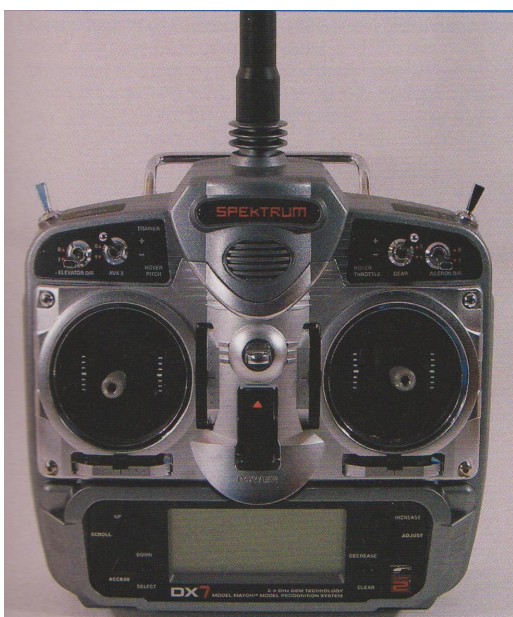
De Spektrum DX7 zender met DSM2 systeem: teveel zendvermogen
