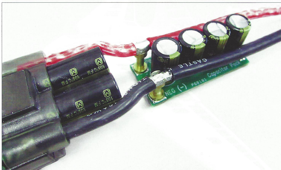
Die zusätzlichen Kondensatoren müssen möglichst nahe am Regler angebracht werden. Bild: Castle Creations
