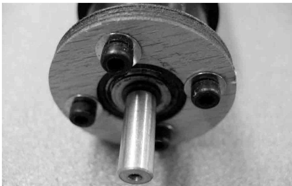
Den Motorspant (1) mit Schrauben (3) und Scheiben (4) auf das Getriebe schrauben
